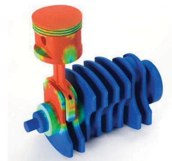
Slika 7. a) proces trodimenzionalnog štampanja 3DP [5], b) 3DP prototip vijčanog kompresora (gore) [1], 3DP prototip u boji (dolje)
