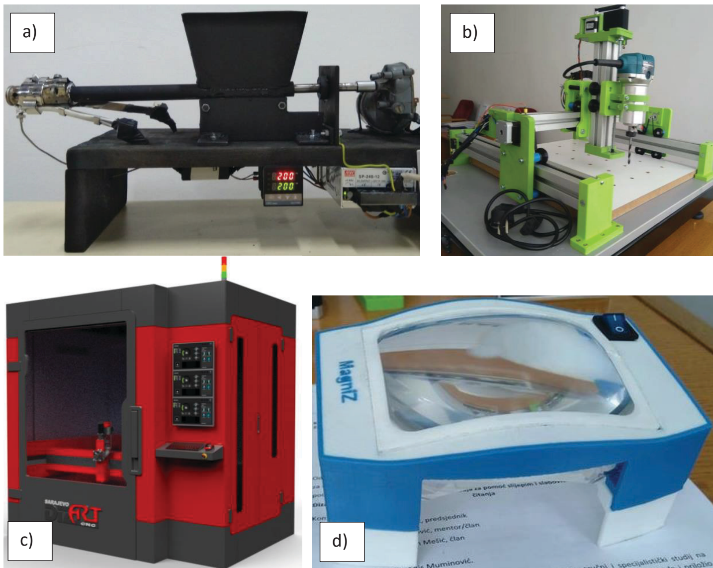
Slika 3. Prototipovi nekoliko razvijenih i izrađenih uređaja u sklopu Laboratorije za razvoj i dizajn proizvoda na Mašinskom fakultetu u Sarajevu: a) uređaj za reciklažu plastičnih materijala i proizvodnju filameta za 3D printanje, b) edukacijska CNC mašina, c) uređaj za hibridnu proizvodnju, d) uređaj za pomoć slabovidnim osobama prilikom čitanja
